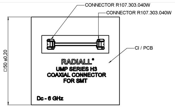
EPAISSEUR CI : 1.6 mm THICKNESS PCB : 1.6 mm
